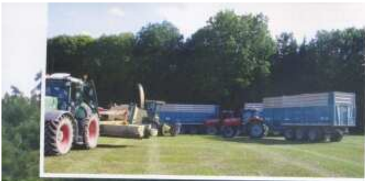
Au champ, une faucheuse Roc aligne deux andains pour alimenter une ensileuse Krone qui déverse dans les quatre remorques Rolland.
