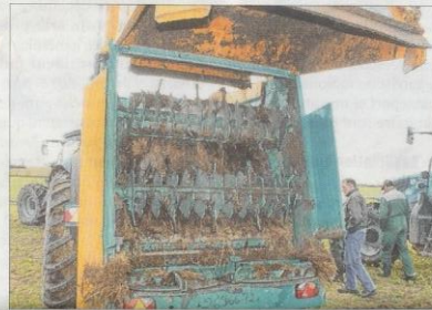
La Cuma des Lilas a fait le choix de s'équiper d'un épandeur à hérissons verticaux et un épandeur à table d'épandage du même modèle Roll force 5517 de 17 m 3 , et équipé du DPA (débit proportionnel à l'avancement) qui fonctionne à vitesses très réduites.
